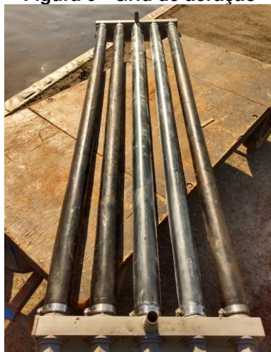
Figura 6 - Grid de aeração
